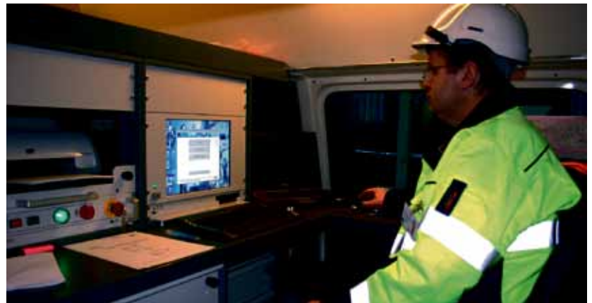
Með nýju og fullkomnu mælitæki Orkuveitu Reykjavíkur er unnt að staðsetja veikleika í jarðstrengjum með mikilli nákvæmni, sem sparar stórfé í viðhaldi og eykur rekstraröryggi.
