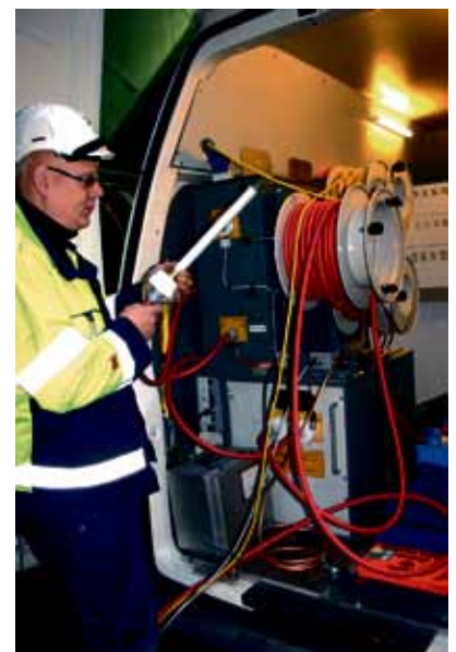
Með nýju og fullkomnu mælitæki Orkuveitu Reykjavíkur er unnt að staðsetja veikleika í jarðstrengjum með mikilli nákvæmni, sem sparar stórfé í viðhaldi og eykur rekstraröryggi.
