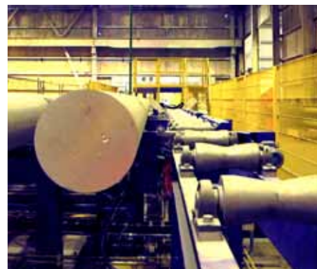
Byrjað er að mata inn bolta á færriböndin frá Hertwich í Steypuskála og er nú hægt að sjá þá hreyfast á hluta kerfisins. Virkniþrófarnir á búnaðnum í heild sinni fer fram í byrjun febrúar. Rúmlega 500 tonn af boltum hafa verið keyptir til að nota við prófarnir á búnaðinum.
